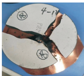
图 10 发生破裂的 MOV 样品 Fig. 10 Fractured MOV samples
