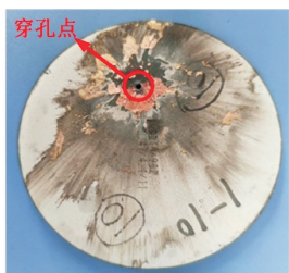
图 12 发生穿孔的 MOV 样品 Fig. 12 Punctured MOV samples
